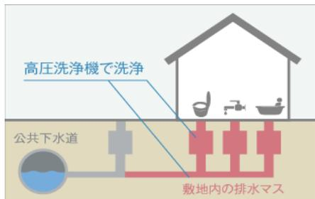
逆噴射ノズルを排水管内に挿入し高圧水の噴射により、排水管内の付着物を取り除き汚れを残さない洗浄方法です。
